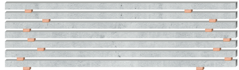
Afb. 2: Badding hout niet in één rechte lijn. Pas op: breekgevaar!
